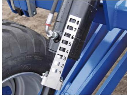
Наличие шкал на копирующих колесах позволяет легко ориентироваться при установке глубины обработки.
