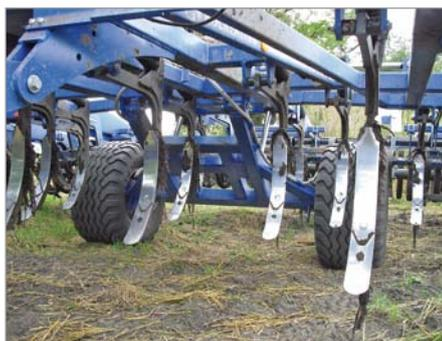
Шаг следа зубьев культиваторной секции составляет 27 см, а следовательно нет потребности в высоком тяговом усилии.
