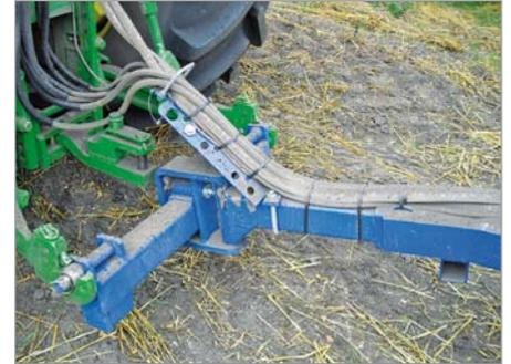
Телескопическое дышло, нижний механизм навески и наличие защитной оплетки на шлангах гидросистемы – неплохое решение.
