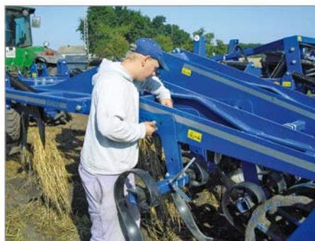
Для регулировки по высоте пластинчатых выравнивателей необходимо переставить болты в соответствующее отверстие.
