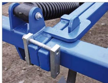
Боковые модули крепятся посредством двух дужковых замков, каждый из которых в свою очередь фиксируется двумя фланцами.
