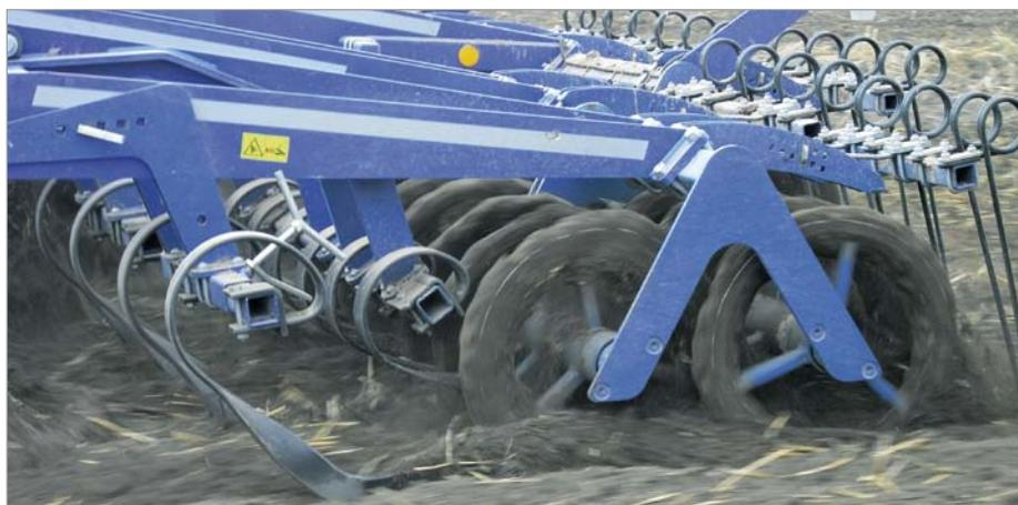
Двойной почвенный каток STS с защитой от забивания уплотняет прежде всего средние и нижние почвенные слои.
