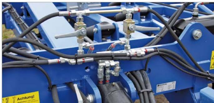
С 2010 года на всех многочисленных запорных кранах гидравлической системы присутствует маркировка.
