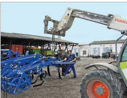
Двое рабочих могут провести монтаж или демонтаж боковых модулей примерно за час работы.
