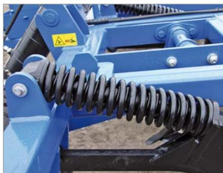
«Необслуживаемый» механизм защиты (спиральная пружина) срабатывает при нагрузке 4,5 кН.
