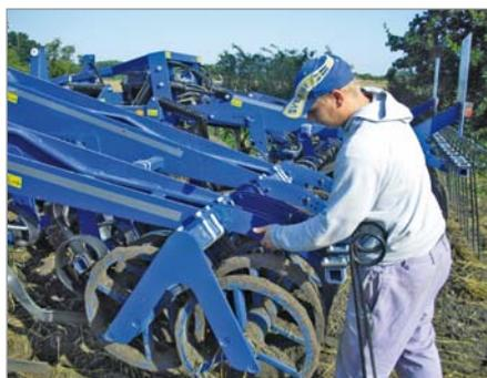
Регулировка секции сетчатой бороны производится сходным образом.
