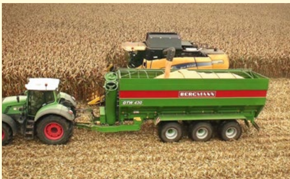
Прицеп-перегрузчик BERGMANN GTW 430 оптимизирует скорость уборки по всей уборочной цепочки.
