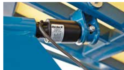
Три измерительных датчика DIGI-STAR® на каждый бункер
