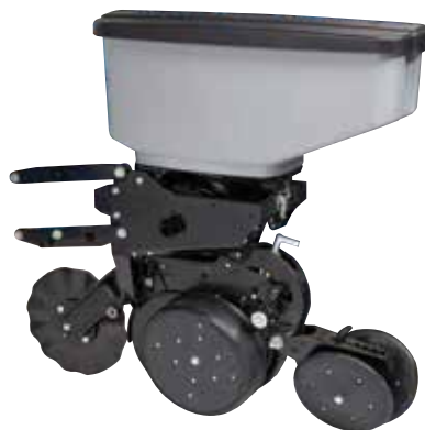
Раздельные бункеры для семян увеличенной емкости объемом 100,5 л
